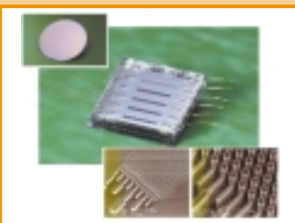
Diamètre des piliers: 15µ
